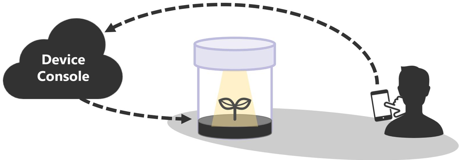
Device Console上でユーザーが設定した点灯スケジュールを取得してLEDの点灯カラー、明るさをコントロールします
